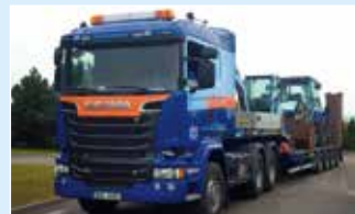
Tahač SCANIA R 520/návěs plošinový Goldhofer/návěs sklápěcí MEILLER - přeprava nadměrných nákladů a sypkých materiálů.
