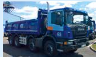
SCANIA P 410 S3 8x4 - přeprava sypkých materiálů, hydraulicky výklopná bočnice (nosnost 18 t).
