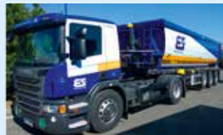
Tahač SCANIA P 410/návěs BODEX - přeprava sypkých materiálů (nosnost 27 t).
