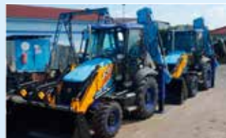
JCB 3CX rýpadlo nakladač (podkopové lopaty 30, 60, 90 naklápací lopata 120, vpředu nakladačová lopata + paletové vidle).
